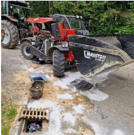
Ölaustritt durch einen geplatzten Hydraulikschlauch am 21.05.2024. Das ausgetretene Öl konnte aufgefangen werden, bevor es zu Umweltschäden kam.
